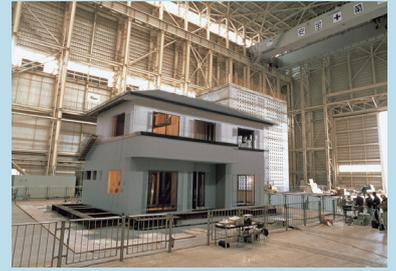
実物大振動実験で震度7をクリア
